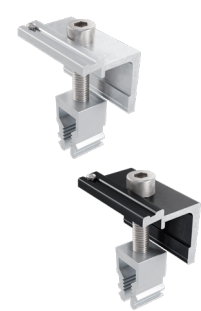
end clamp 36-42 uni ic 50 with pin / endklemme 36-42 uni ik 50 pin material: EN AW-6063 T66 / A2-70
